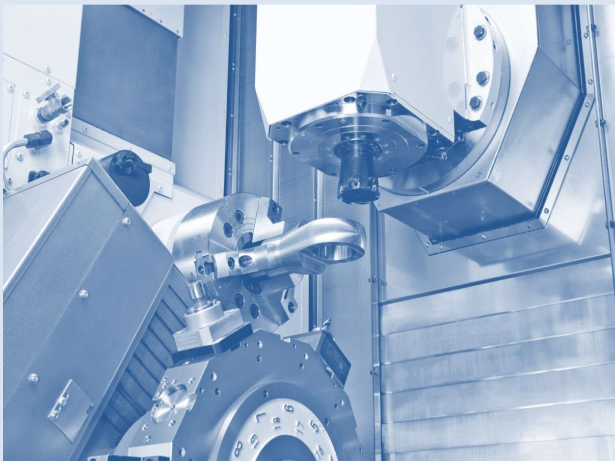
Figuur 81 Schema MultiTasking 5-assige draai-freescentrum
